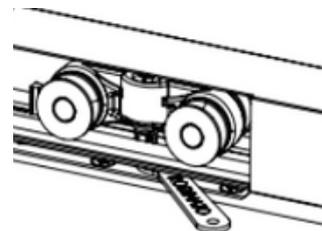
3º Deve-se fazer um corte de uma extremidade a outra na parte inferior da porta. Após fazer o corte, fixar o trilho na parte inferior da porta. Conforme figura 01. A instalação do guia reto deve ser realizada no chão, sendo parafusado.
