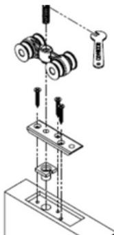
2º Cortar o trilho no comprimento desejado e fixa-lo no local de sua escolha. A porta deve ter no mínimo 10cm a mais na largura, que o vão a ser fechado. O perfil deve ter no mínimo o dobro do tamanho da porta. Após a fixação do trilho superior, posicionar as roldanas de 4 rodas juntamente com a porta no local desejado.
